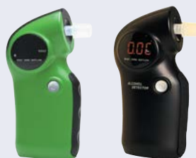
AL6000Lite / A szenzor modul nem cserélhető. Csak Normál üzemmód van.
